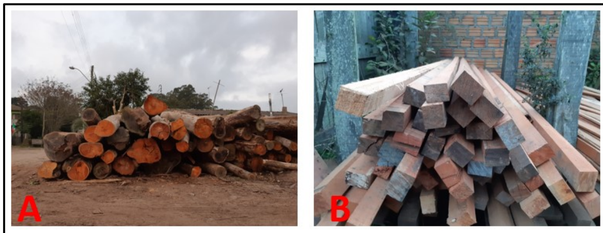
Figura 101 - A – troncos do eucalipto vermelho e B – Peças beneficiadas para uso nas ossaturas.
