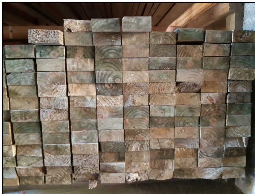
Figura 57 - Seção transversal de montantes (38 mm x 89 mm) mostrando os anéis de crescimento. 17
