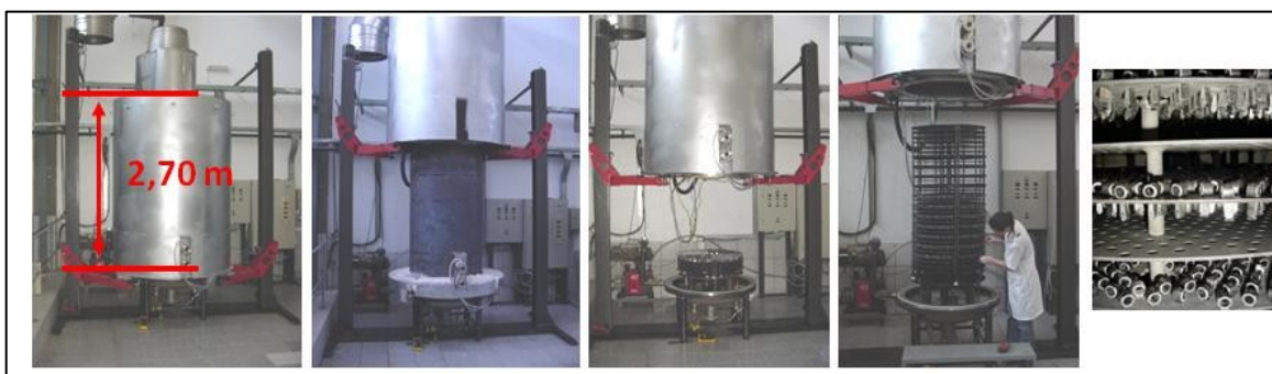
Figura 1.3 - Reator piloto, em escala industrial, com extração de óleo e nitretação por plasma em ciclo único, com capacidade de 10.000 bielas
