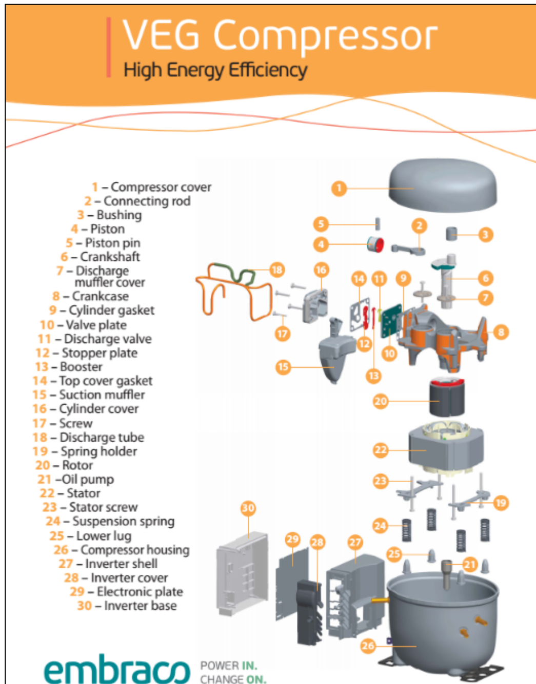
Figura 4.12 – Vista explodida de um compressor hermético típico.
