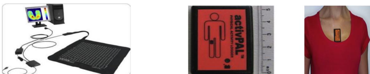
Figura 15 – Sistema de mapeamento de pressão da interface XSensor X3 e acelerômetro Activpal3
