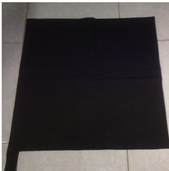
Figura 14 – Colchão de pressão: PS-256 de matriz 18X18 com 256 sensores de pressão
