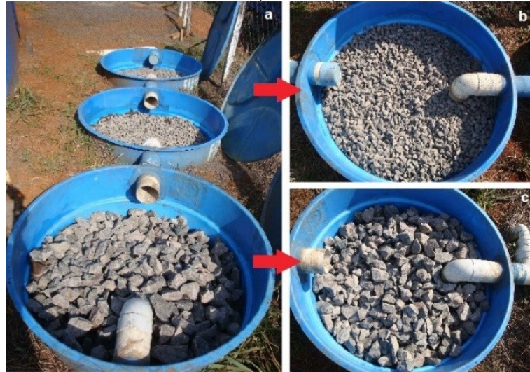
Figura 7. a) Filtração rápida com três filtros em série; b) filtração com pedra britada de menor granulometria para polimento final (3º filtro); c) filtração com pedra britada de granulometria maior (1º filtro).
