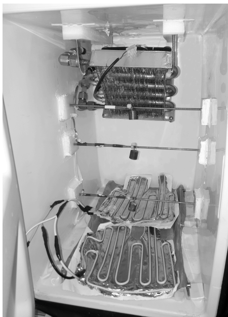
Figura 13 – Procedimento experimental para determinação da condutância térmica global do gabinete
