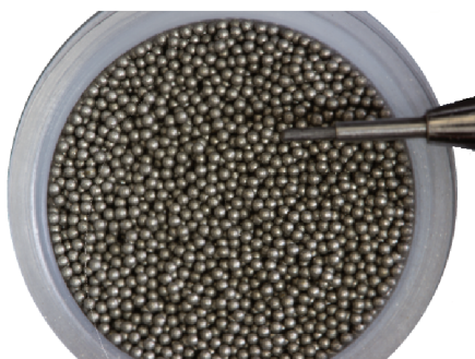
Figura 9 – Esferas de liga de gadolínio utilizadas na montagem do regenerador. (Ponta de grafite 0,5 mm para referência do diâmetro das esferas)
