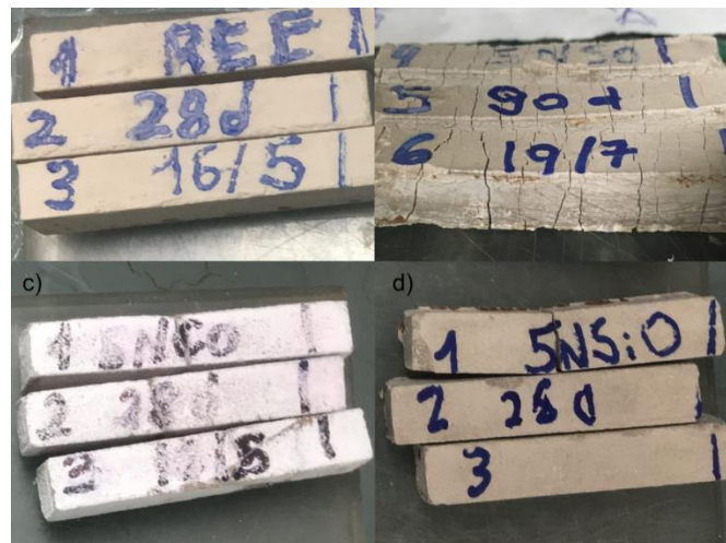
Figura 41. Aparência física das pastas após 28 dias de exposição ao ar para a) REF, b) 5NS, c) 5NC e d) 5NSi
