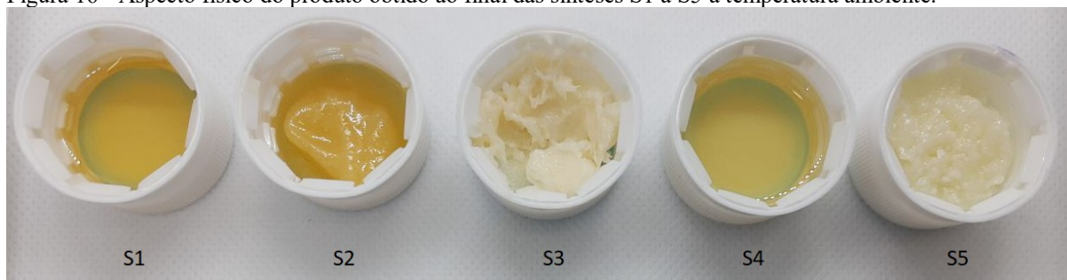
Figura 16 - Aspecto físico do produto obtido ao final das sínteses S1 a S5 à temperatura ambiente.
