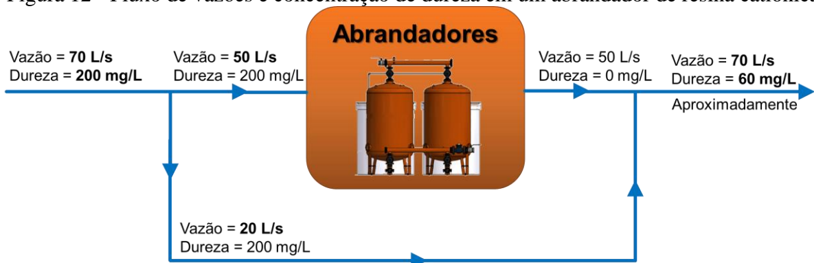
Figura 12 - Fluxo de vazões e concentração de dureza em um abrandador de resina catiônica.
