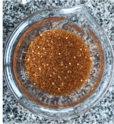
Figura 2 - Resina catiônica fortemente ácida Purolite® C100.
