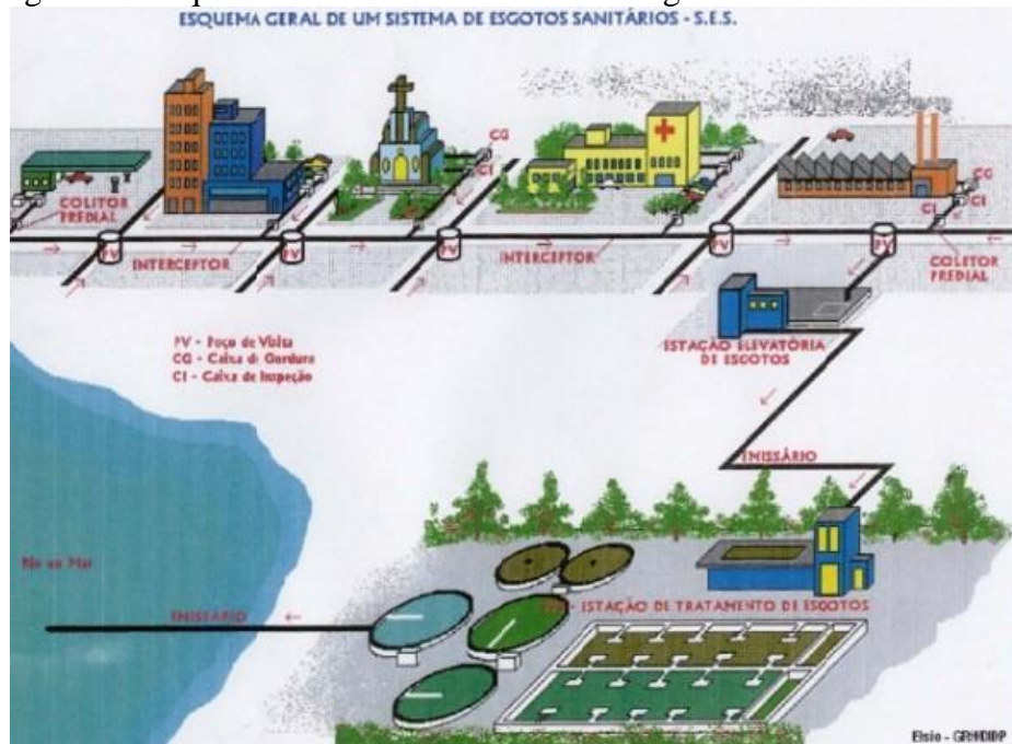
Figura 2 – Esquema Geral de um Sistema de Esgotamento Sanitário - SES
