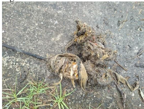
Figura 29 – Resíduo retirado da bomba
