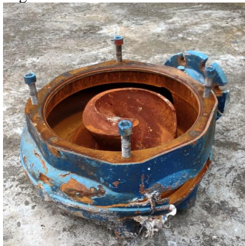
Figura 30 – Rotor da Bomba EEE C1
