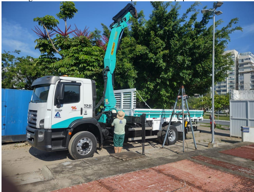
Figura 35 - Caminhão Munck - Operador de Equipamento Pesado
