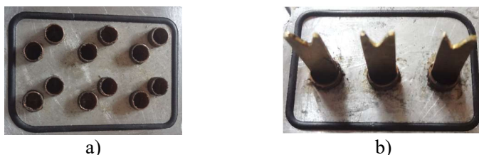
Figura 27 - Sistema de vedação utilizado entre placa suporte de refrigeração e insertos para a) canal complexo b) palhetas.
