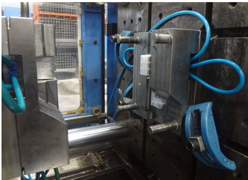
Figura 47 - Produto preso no lado fixo devido ao gradiente de temperatura no molde.
