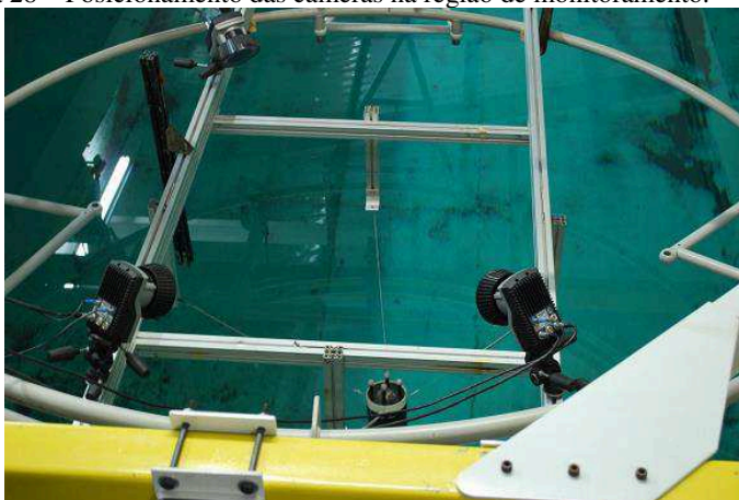
Figura 28 – Posicionamento das câmeras na região de monitoramento.
