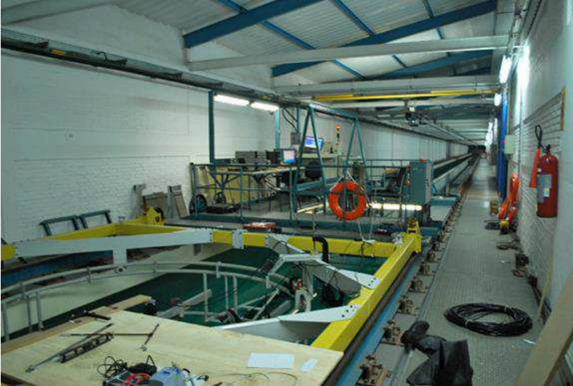
Figura 22 – Carros principal e secundário do Tanque de Provas do IPT.
