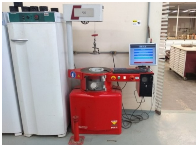
Figura 7.2–Prensa de Compactação Giratória (PCG-3).
