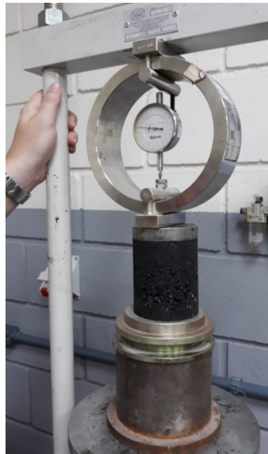
Figura 7.9–Processo de rompimento do corpo de prova de Duriez.
