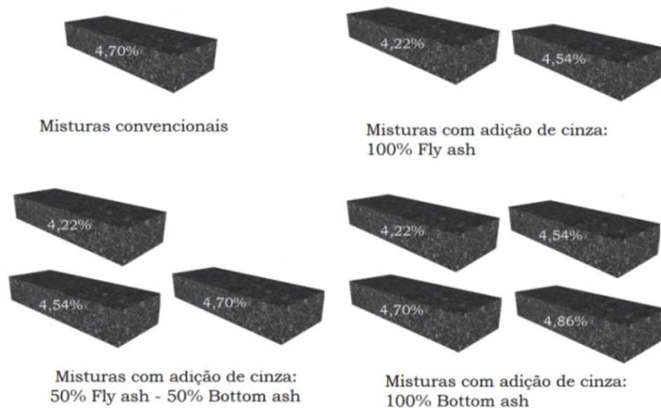
Figura 8.7–Corpos de provas realizados no ensaio de deformação permanente.
