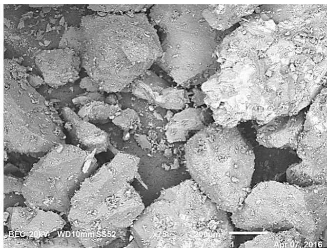
Figura 6.7–Microscopia eletrônica de varredura, finos de diâmetro 0,3mm de agregado granítico da região de Joinville.
