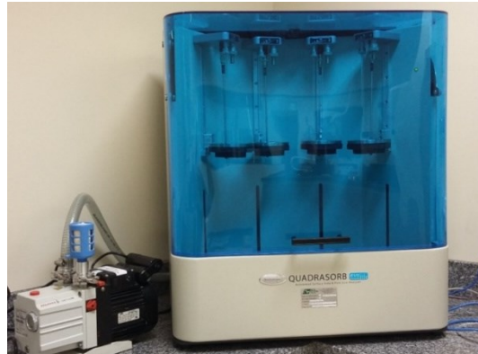
Figura 6.11–Analisador de área superficial e propriedades de poros.
