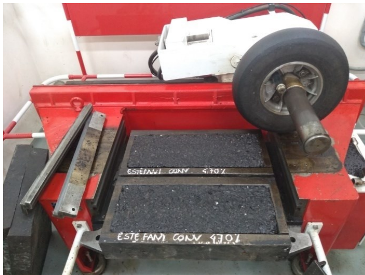
Figura 7.11–Equipamento para compactação das placas de misturas asfálticas.
