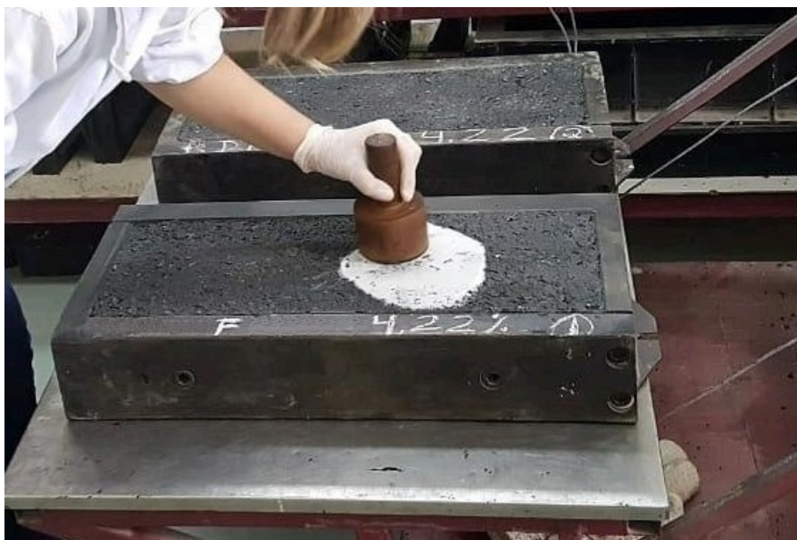
Figura 7.14–Ensaio de mancha de areia.
