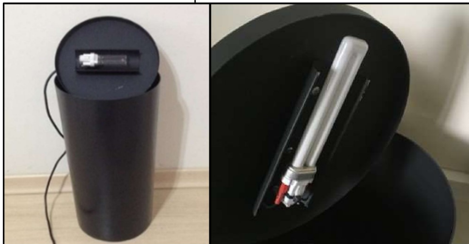
Figura 23 - Equipamento para irradiação e ativação do filme fino por UV-A e UV-C utilizado no presente trabalho.
