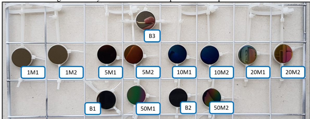
Figura 28 - Layout das amostras no porta-amostra para imersão.
