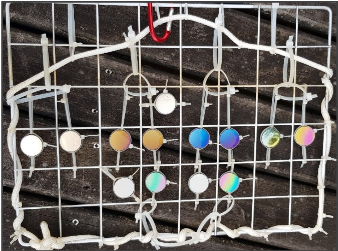
Figura 27 - Imagem ilustrando o porta-amostros com as amostras fixadas antes da imersão em ambiente marinho.
