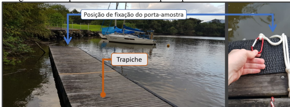
Figura 26 - Trapiche utilizado como suporte para imersão das amostras.
