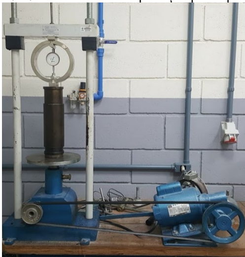
Figura 7.17 - Processo de compactação por duplo pistão
