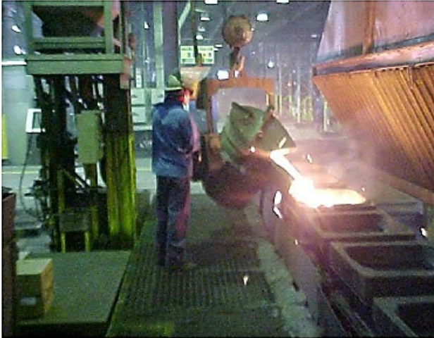
Figura 2.4 - Metal líquido sendo vertido na caixa de moldagem
