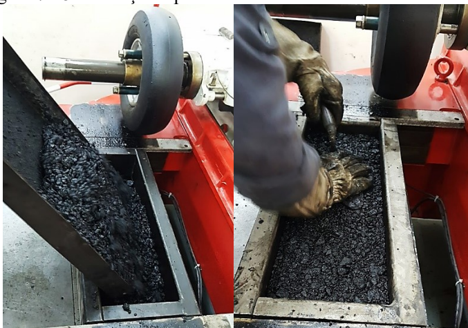
Figura 7.28 – Inserção e pré-adensamento/nivelamento da amostra
