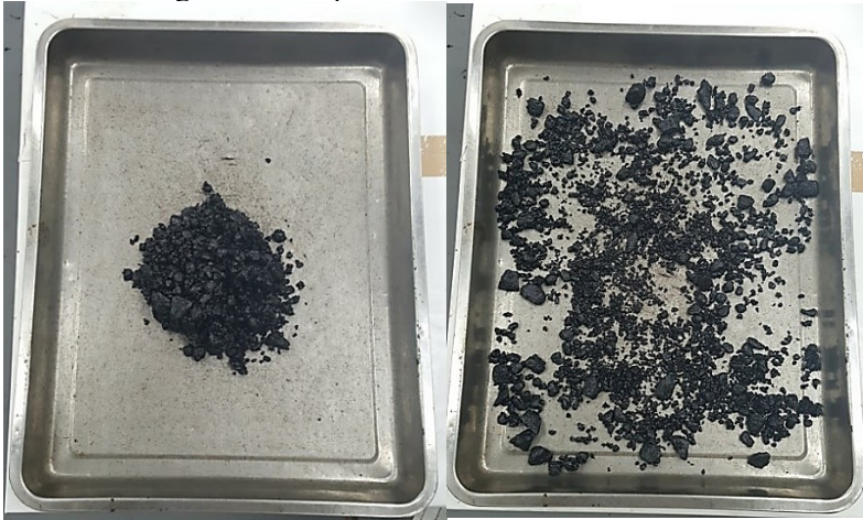
Figura 7.1 - Espalhamento da mistura asfáltica
