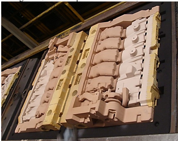
Figura 2.3 - Macho posicionado dentro do molde
