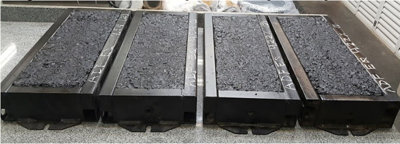
Figura 7.29 - Placas moldadas pela mesa compactadora pneumática
