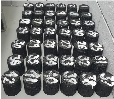
Figura 7.18 – Corpos de prova condicionados sem imersão
