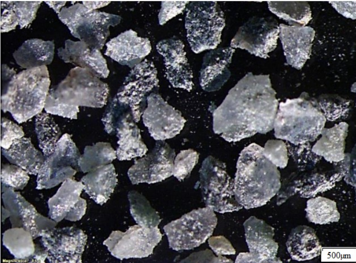
Figura 6.5 - Imagem microscópica de elevada resolução. Brita retida na 0,30mm
