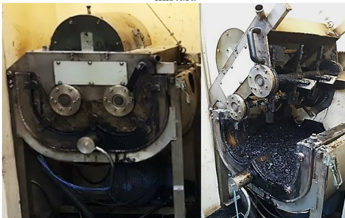
Figura 7.26 - Pugmill fechado(esq.) e aberto(dir.) para retirada da mistura
