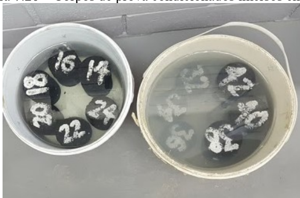
Figura 7.20 – Corpos de prova condicionados imersos em água
