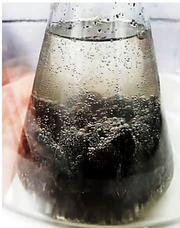
Figura 7.3 - Bolhas de ar aprisionadas sendo expulsas sob pressão à vácuo
