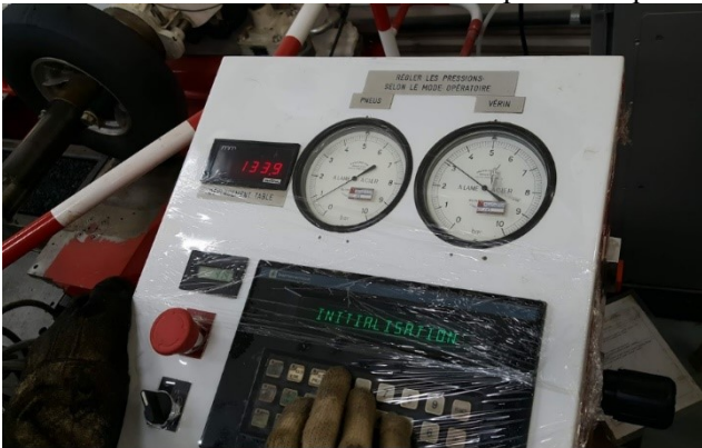
Figura 7.24 - Painel de controle da mesa compactadora pneumática
