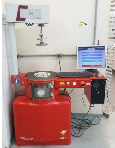
Figura 7.6 - Prensa de Compactação Giratória (série PCG-3)
