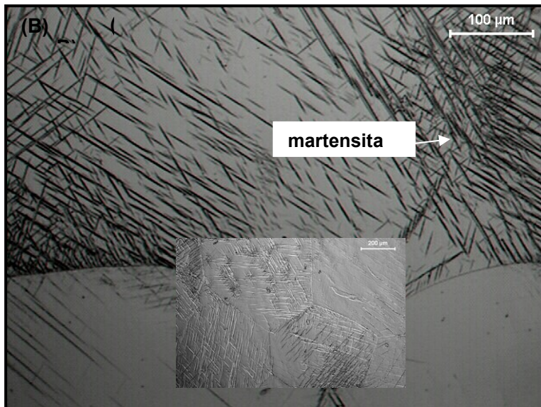
Figura 9: Micrografia óptica da liga Ti-10Mo-6Nb tratada termicamente, nas regiões: (A) central e (B) inferior. Ataque químico: solução Kroll.
