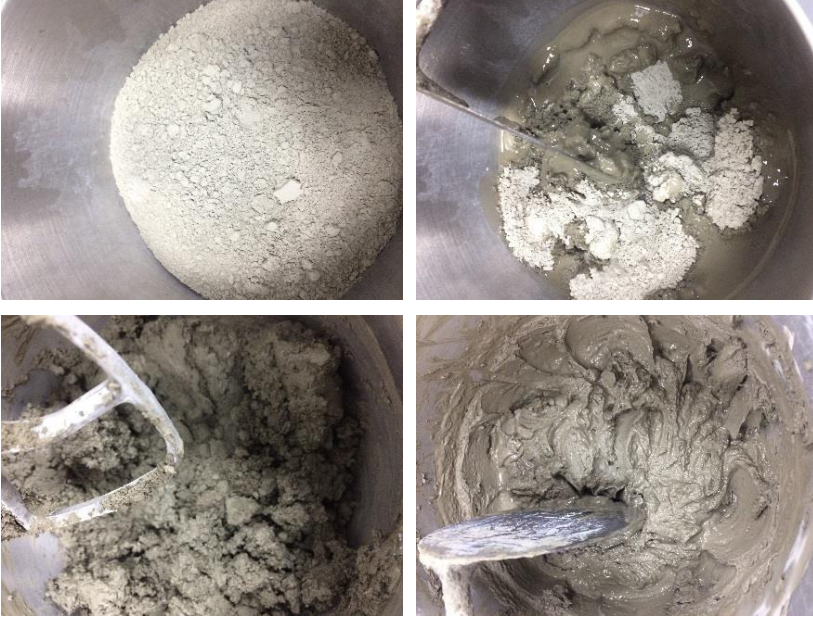
Figura 23 - Etapas de mistura para a preparação da pasta de cimento
