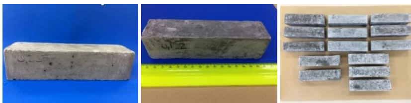
Figura 37 - Corpos de prova prismáticos ( 4 \times 4 \times 16 cm 3 )
