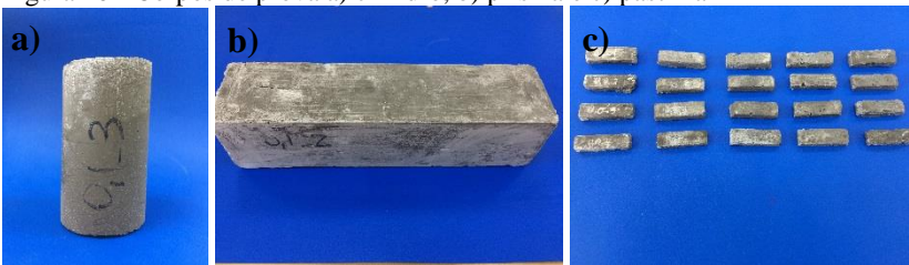
Figura 20 - Corpos de prova a) cilindro, b) prisma e c) pastilha
