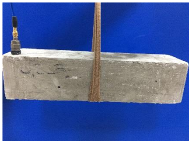
Figura 31 - Configuração de apoio e posição do acelerômetro para o IET
