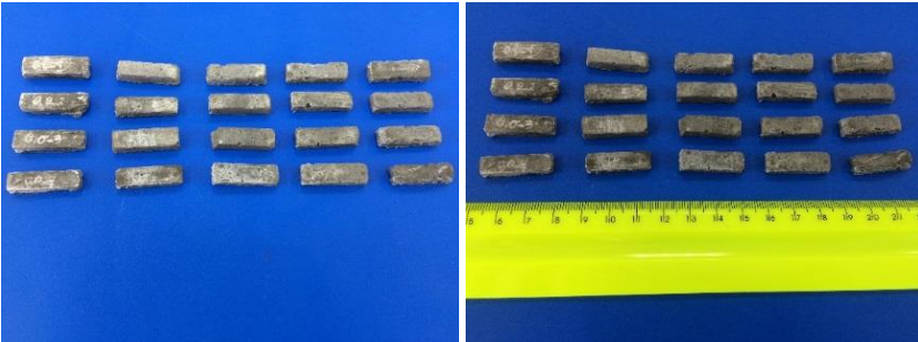
Figura 39 - Corpo de prova pastilha ( 26 \times 10 \times 5 \text{ mm}^3 )
