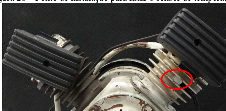
Figura 26 – Ponto de instalação para fixar o sensor de temperatura.
