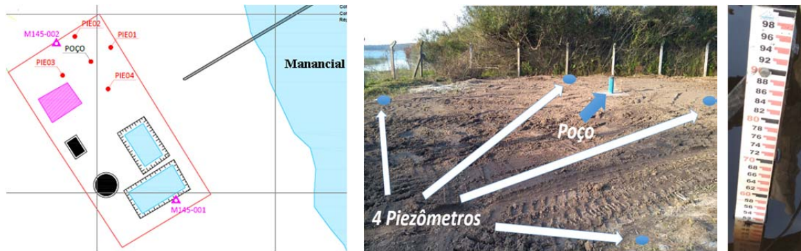
Figura 67 - Esquema demonstrando a localização do poço de produção e piezômetros com relação ao manancial – vista em planta (à esquerda) e imagem local indicando os mesmos
