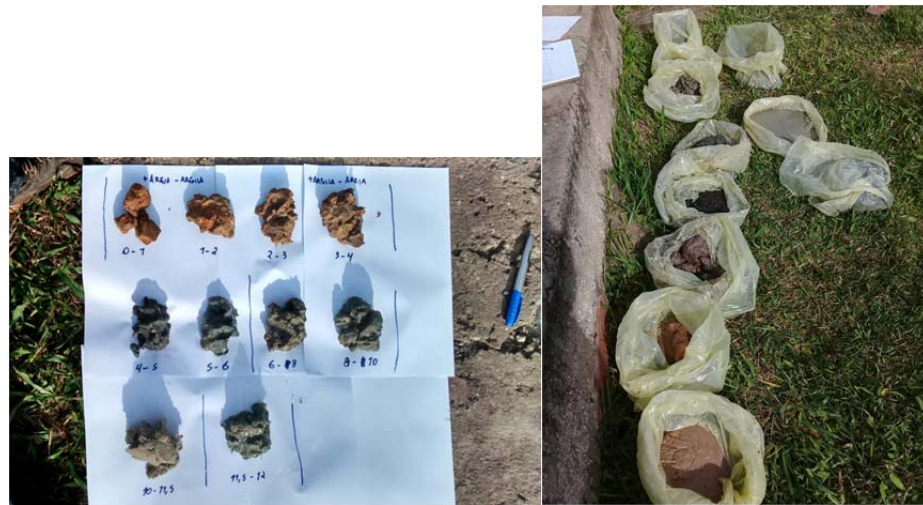
Figura 69 - Coleta de amostras do perfil do poço e piezômetros para análise granulométrica e de teor de material orgânico
