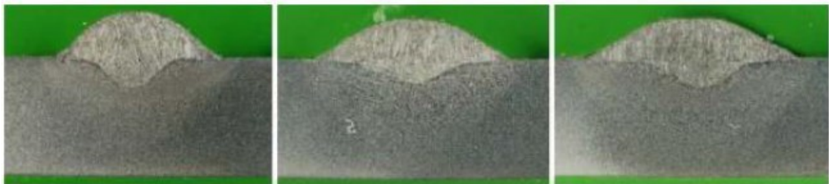
Figura 41 – Resultados obtidos a partir da variação do balanço de correntes para o Plasma-GMAW coaxial [4].
