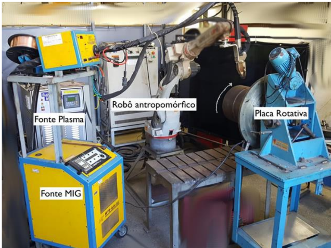
Figura 66 – Bancada de ensaios para soldagem em Tubo.
