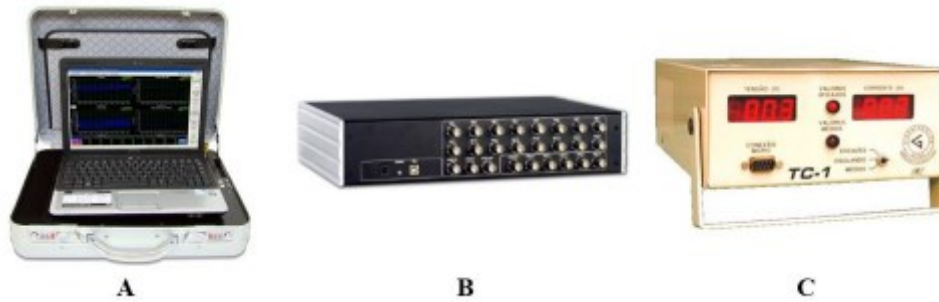
Figura 53 – Sistemas de aquisição de dados (A- Sistema de aquisição de dados portátil (SAP); B- MotionPro DAS; C- TC-1).
