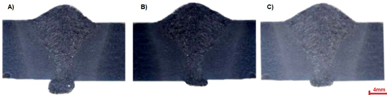
Figura 109 – Macrografias resultantes para soldas realizadas com três tipos diferentes de backing (A) Cerâmico, (B) Fibra de Vidro e (C) Cobre.
