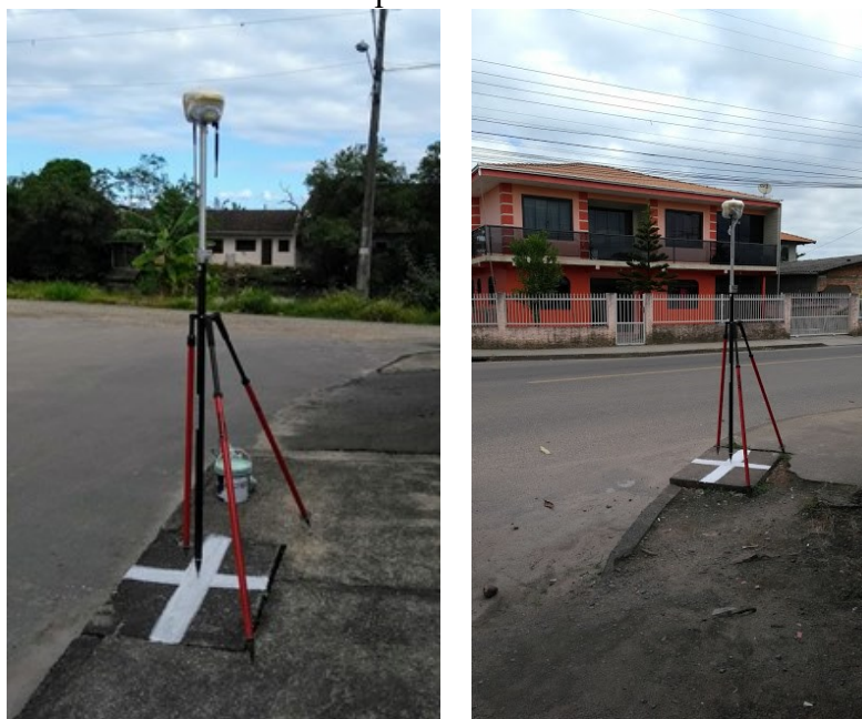
Figura 35 - Levantamento coordenadas com o método RTK convencional e NTRIP dos PCT materializados em solo em tinta ou placas de PVC de cor branca e forma de cruz.
