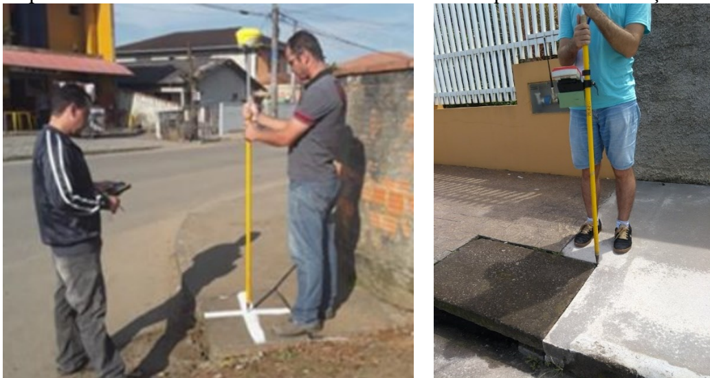
Figura 34 - Levantamento das coordenadas em campo utilizando feições demarcadas com pintura em forma de x com tinta branca sobre o solo pavimentado e feições existentes.
