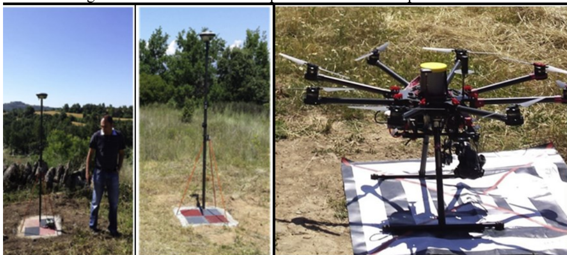
Figura 12 – Alvos executados para os PCT e octocoptero utilizado
