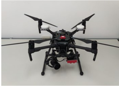
Figura 43 - Equipamento Matrice 210 RTK com câmeras ZenmuseX5S e multiespectral RedEdge (a,b), planos de voos realizados pelo software DroneDeploy (c), instalações da base RTK do Matrice 210 e da base RTK para medição das coordenadas dos PCT por GNSS (d) e decolagem do Matrice210 na cobertura do edifício do EFI, UFSC (e).
