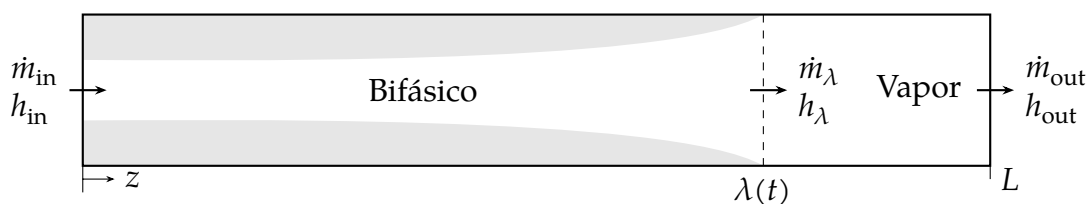
Figura 35 – Esquema de um evaporador com fluido em mudança de fase
