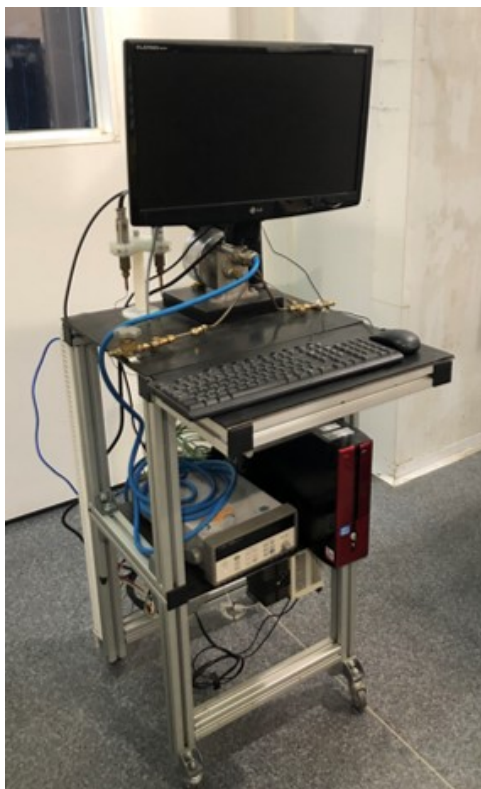
Figura 28 – Bancada para medição da vazão de Nitrogênio em tubos capilres
