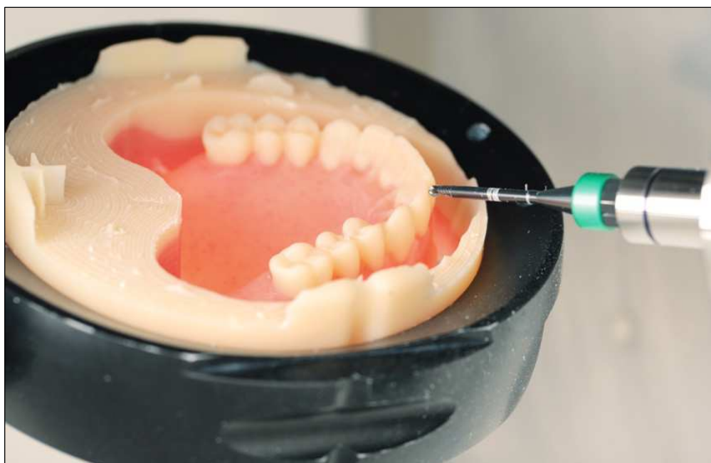
Figura 2. Bloco de PMMA sendo fresado pelo método subtrativo em uma Fresadora Programill® (Ivoclar Vivadent®, Lichtenstein).
