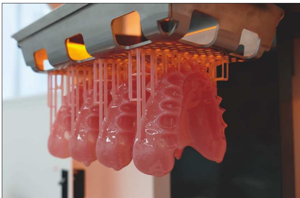
Figura 3. Método aditivo de prototipagem rápida (impressão 3D). Impressora NextDent® 5100 (NextDent®, Holanda). Fonte: http://www.dentalasia.net/en/news-archive/dentures-at-unbeatable-speed-and-cost-effectiveness/2657
