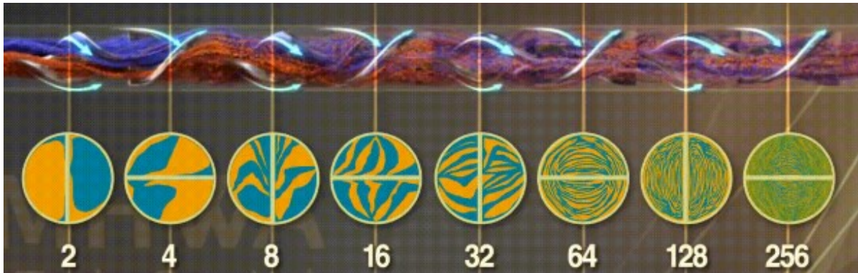
Figura 3 - Número de divisões nas correntes para um misturador com até oito elementos de mistura Kenics.
