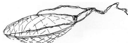
a fim de dar certo equilíbrio ao sistema quanto este é içado à passarela com o peixe dentro. As três cordas juntam-se em uma, que precisa ter mais do que 30m de comprimento — altura aproximada da passarela até a superfície da baía, podendo variar conforme a enchente ou a vazante. Por fim, importa destacar que apesar de haver *jererés* a venda no mercado, há possibilidade de individuações a partir da manufatura de aproveitamento
