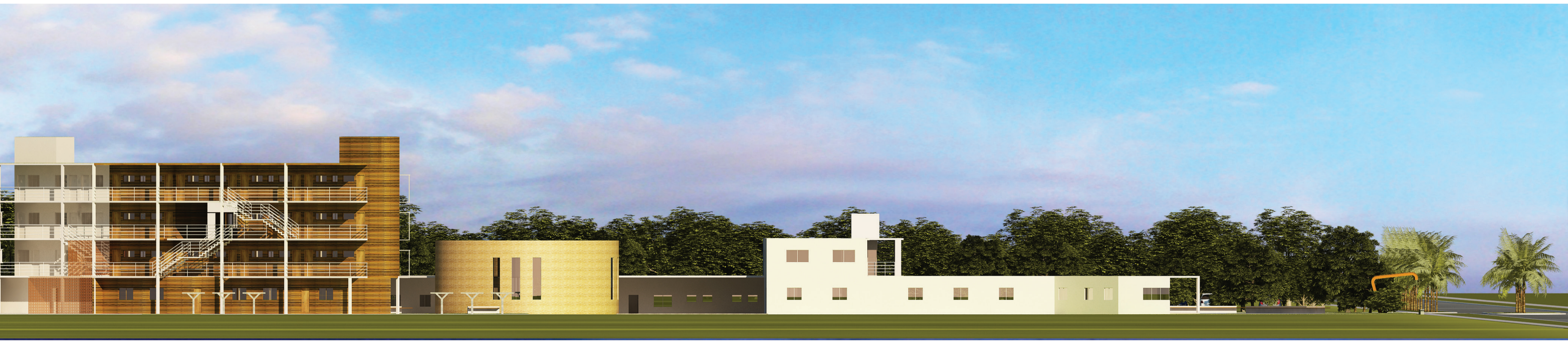
Ventilação horizontal, aquecimento solar passivo e diminuição temperatura superficial.
