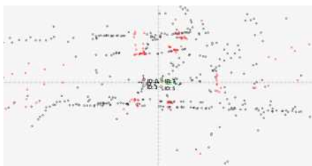
Figura 12 – Vista de cima de todos os objetos detectados por todos os radares do cinturão
