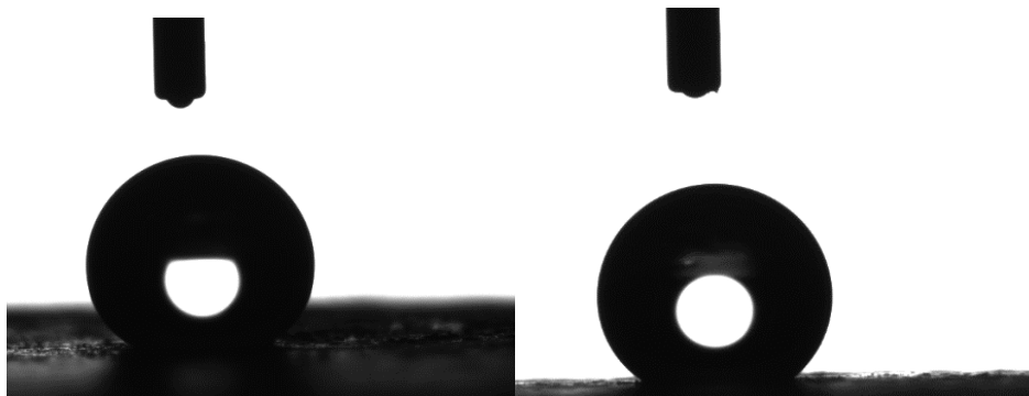
Figura 34 – Gota de água sobre as superfícies lixadas com granulometria 320 e (a) sem ativação da superfície do cobre e (b) com ativação de superfície
