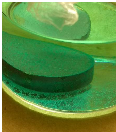
Figura 28 –Óxidos decantados no fundo do Becker e sobre a amostra, sem a formação de uma camada protetora sobre a peça
