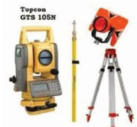
Figura 6 - Estação total, tripé, bastão e prisma.
