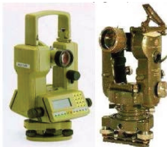
Figura 5 - Teodolito eletrônico e óptico-mecânico
