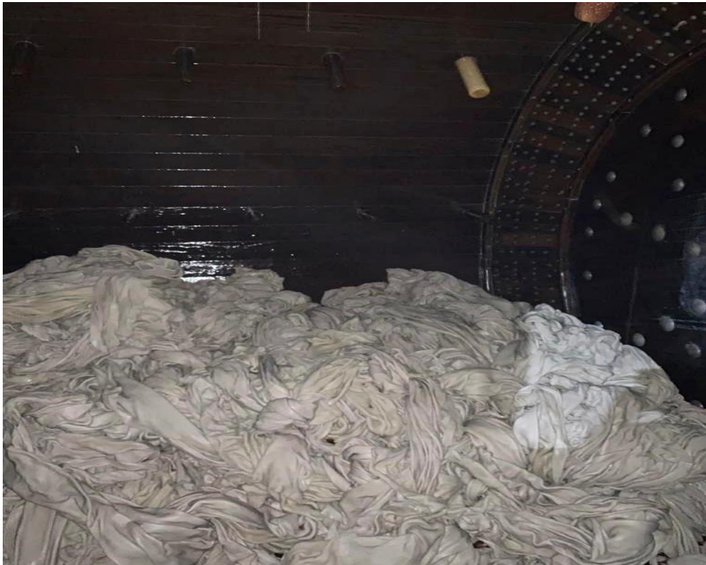
Figura 10 – Interior de fulão com peles curtidas ao vegetal
