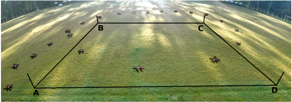
Figura 58 – Sobreposição de quadros a cada 2 segundos do voo com o quadricóptero em trajetória circular e guinada livre.
