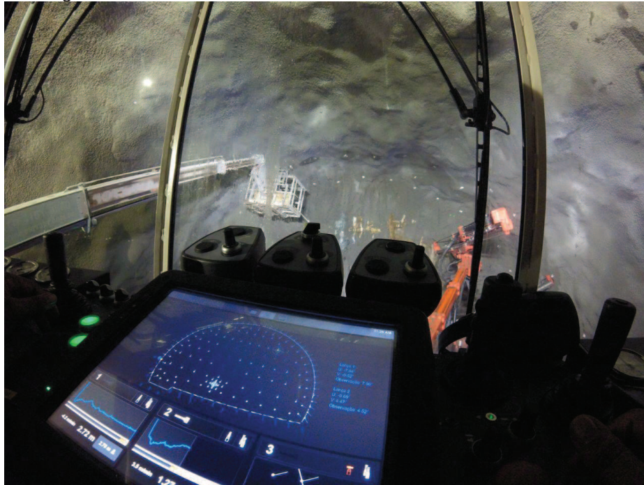
Figura 19 – Interior da cabine do Jumbo com vista do sistema TCAD.
