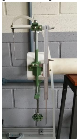
Figura 4 – Paquímetro acoplado ao tubo de Pitot
