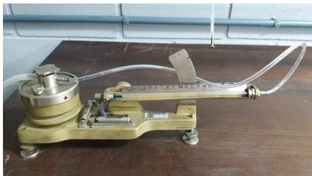
Figura 3 – Manômetro utilizado para medição de pressão
