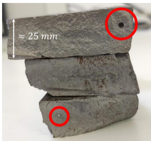
Figura 25 – Fragmentos do lingote de La-Fe-Si no estado bruto de fusão.
