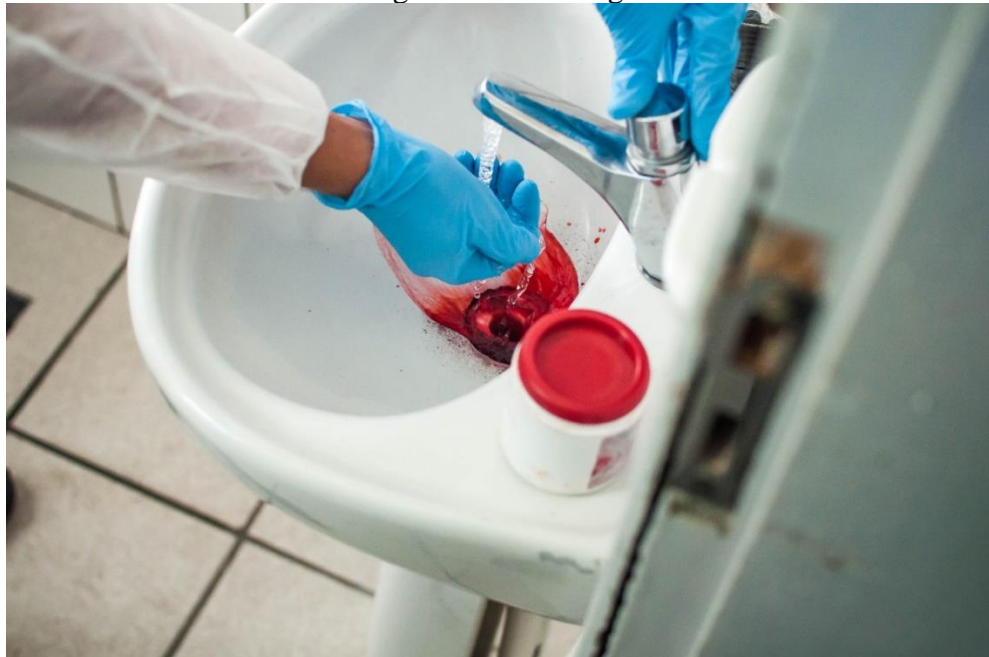
Figura 11 – Foto ilustrativa de um teste com corante alimentício para identificação de ligação de esgoto à rede de esgoto.
