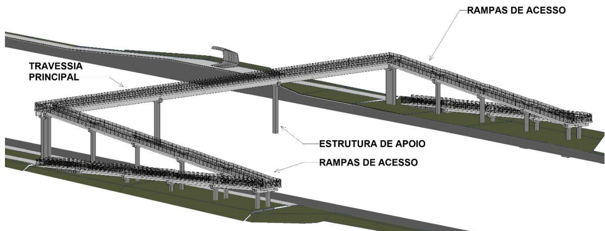
Figura 2 - Estruturas componentes de uma passarela
