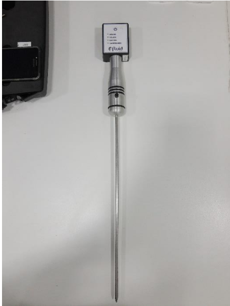
Figura 62 – Haste de escuta 4Fluid.
