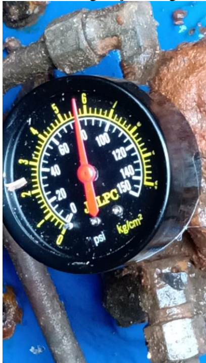
Figura 102 – Configuração antiga, 58 mca.
