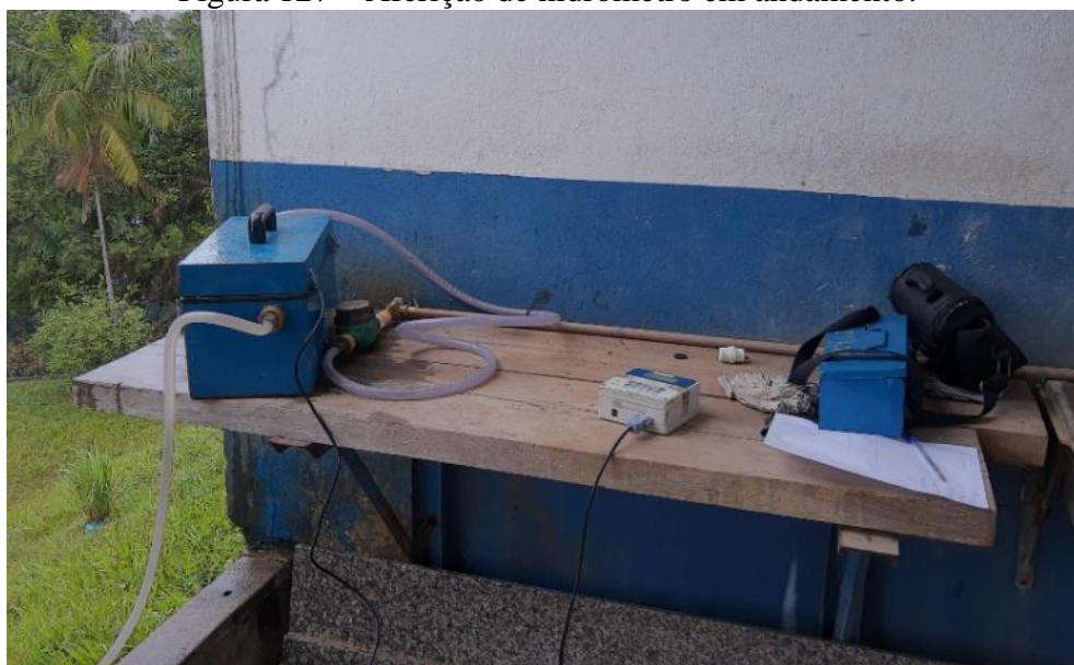
Figura 127 – Aferição de hidrômetro em andamento.
