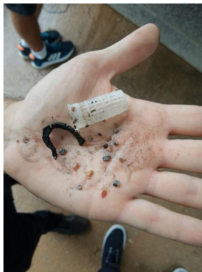
Figura 126 – Sólidos encontrados na peneira do hidrômetro.
