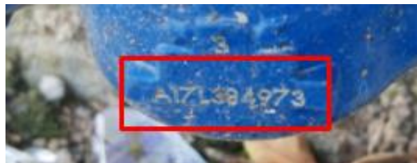
Figura 67 – Código de identificação hidrômetros, conforme NBR NM 212/02.
