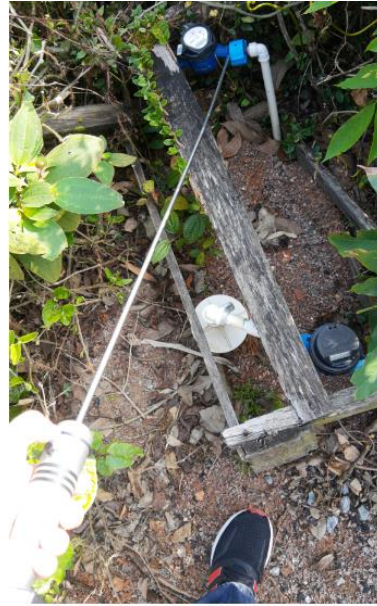
Figura 63 – Coleta de áudio, haste 4Fluid.
