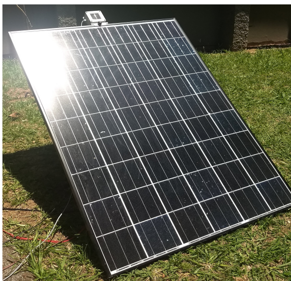
Figura 6.4 – Ensaio ao ar livre: (a) Inclinação de 45^\circ ; (b) Inclinação paralela ao solo.
