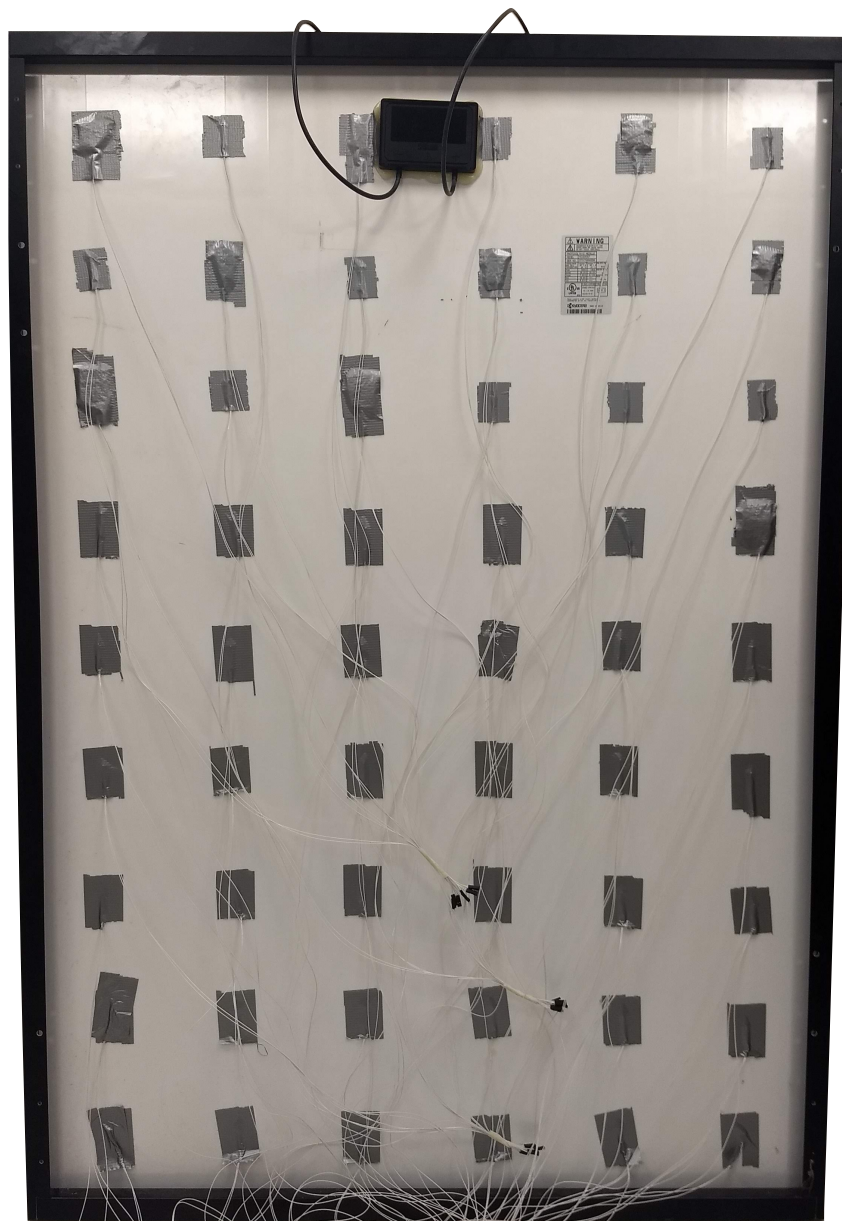
Figura 6.2 – Visão posterior do módulo com termistores fixados
