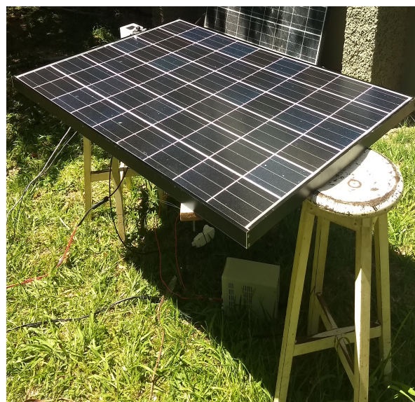
Figura 6.4 – Ensaio ao ar livre: (a) Inclinação de 45^\circ ; (b) Inclinação paralela ao solo.
