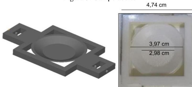
Figura 5: À esquerda temos a fotografia do aparato campo aberto utilizado para impressão e à direita uma fotografia do mesmo com suas medidas. Fonte: própria autora.
