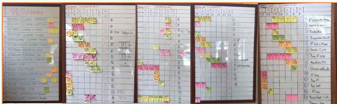
Figura 10 – Exemplo da seção de planificação Pull em uma fase da obra Vertical 60, Santa Cruz Bolívia.
