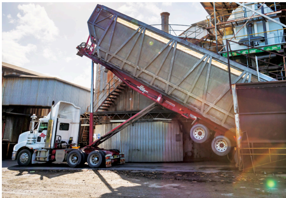
Figura 3 – Caminhão realizando o descarregamento da Bin na usina de processamento.
