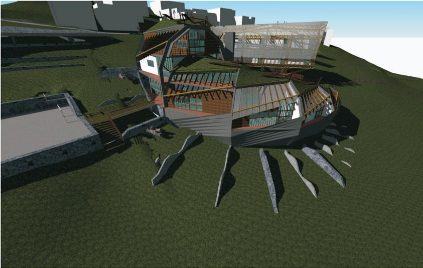
Perspectiva com as biovaletas de bloco de concreto e arrimos de pedra
