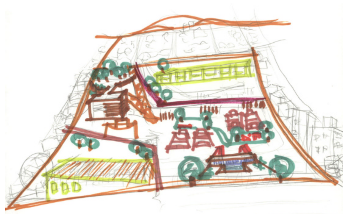
Croquis 01 retrata intenção de implantação, com dois blocos, cada um conectando-se de um forma com a via adjacente. A parte central do terreno, plana, comportará os equipamentos esportivos e áreas abertas. Os taludes, assim como os cantos do sítio, serão tratados de forma a abrigar elementos (arquibancadas, halves,...).
