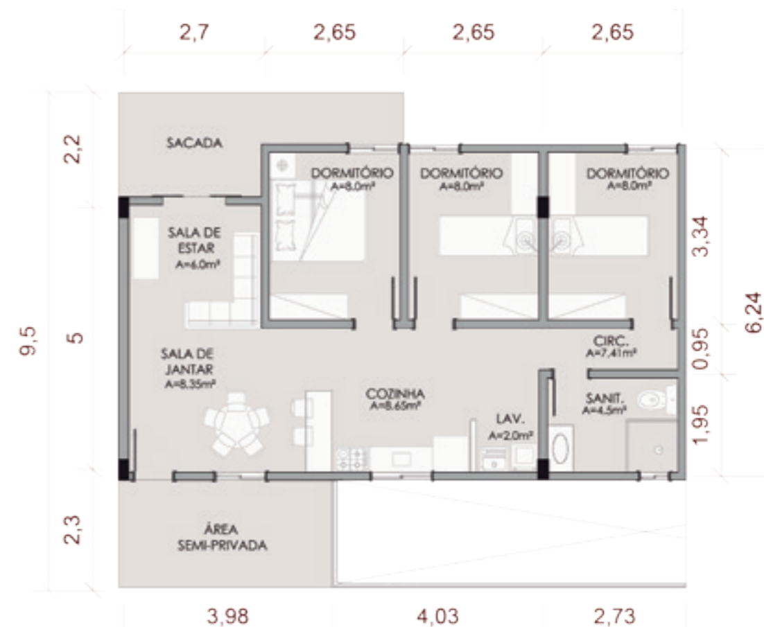
TIPOLOGIA 5: 3 dormitórios ESC.: 1/100 ÁREA: 66,5m 2
