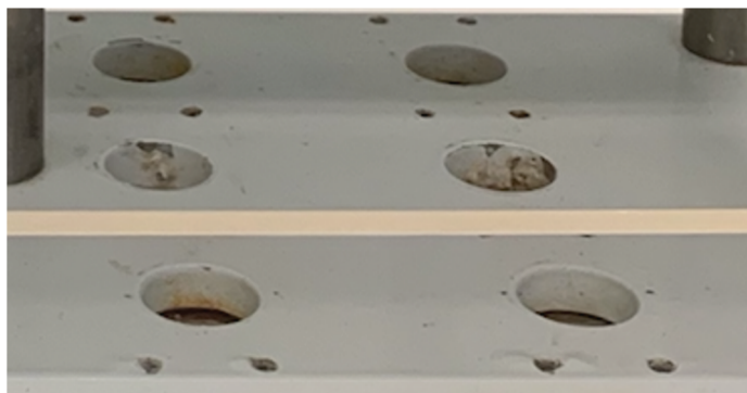
Figura 4 – plataforma metálica com as circunferências de inserção dos espécimes.
