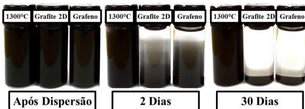
Figura 81 - Estabilidade de suspensões de óleo POE contendo diferentes partículas de carbono.
