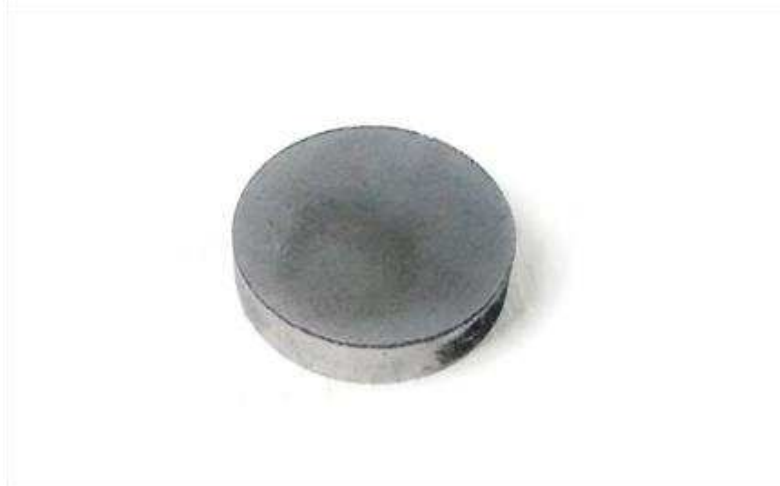
Figura 46 – Aspecto de uma amostra de aço impregnada com as partículas de carbono após realização de tratamento térmico nas partículas.
