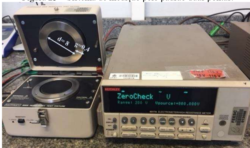
Figura 23 – Sistema de medição pelo padrão duas pontas.
