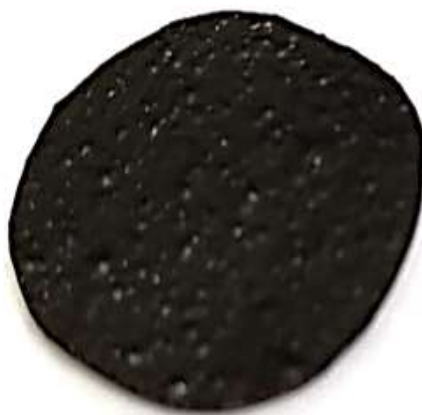
Figura 18 – Amostra de 4 %m fabricada pela rota 1D preparada para ser utilizada no ensaio eletromecânico.
