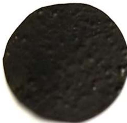
Figura 20 – Amostra de 4 %m fabricada pela rota 2D preparada para ser utilizada no ensaio eletromecânico.
