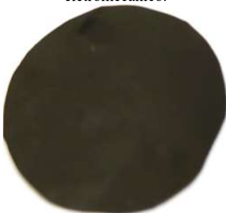
Figura 22 – Amostra de 4 %m fabricada pela rota 3D preparada para ser utilizada no ensaio eletromecânico.
