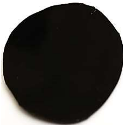
Figura 16 – Amostra de 4 %m fabricada pela rota 0D preparada para ser utilizada no ensaio eletromecânico.
