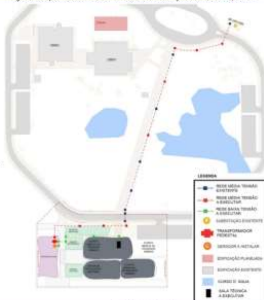
Figura 6.7: Proposta de encaminhamento do circuito de alimentação do transformador pedestal
