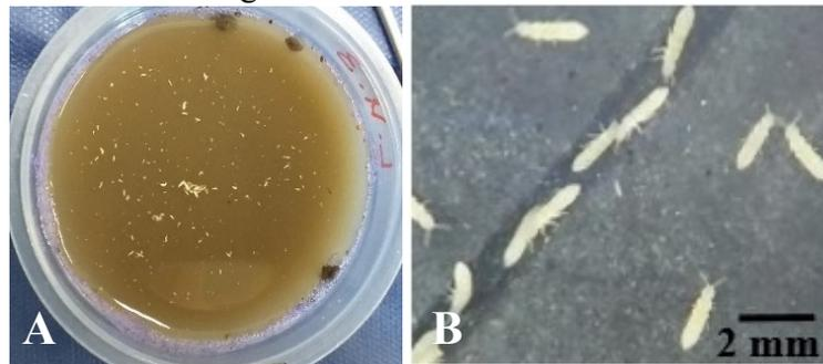
(A) Leitura de um ensaio com *F. candida*, aonde é possível observar os colêmbolos flutuando na superfície do líquido. (B) Imagem de um dos recipientes utilizados para a criação dos organismos-teste, cujos exemplares são visualizados a partir da fotografia em lupa (40x).
