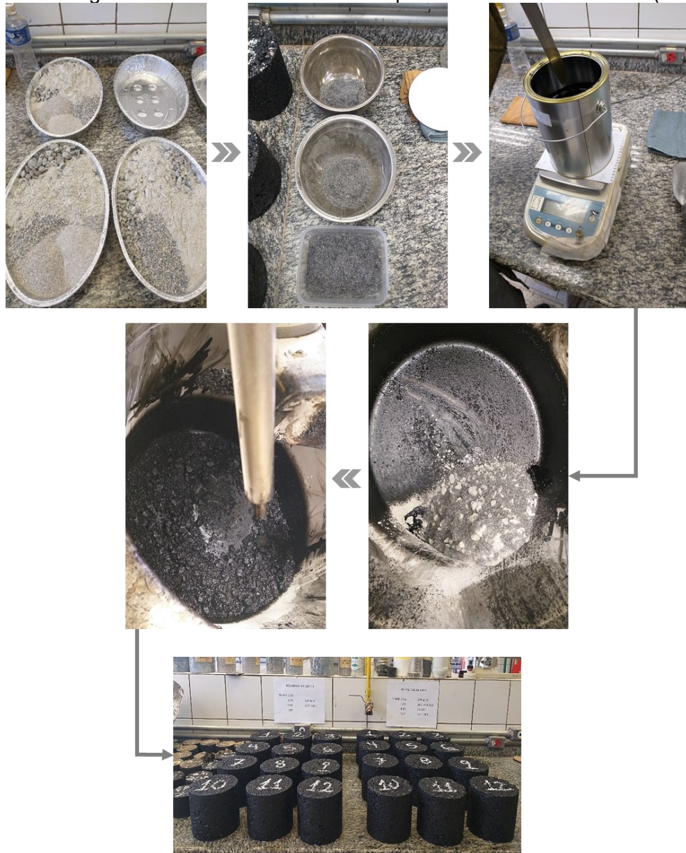
Figura 29 - Sequência das etapas executadas para confecção dos corpos de prova referentes à dosagem da mistura modificada e comparativo entre CPs dosados (última foto).
