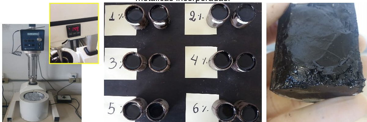
Figura 26 – Conforme sequência: (1) misturador de alto cisalhamento Silverson L5M-A com controle da temperatura, (2) aspecto da amostra após o processo de modificação, no interior do molde e (3) amostra partida, na qual é possível observar a deposição das fibras metálicas incorporadas.
