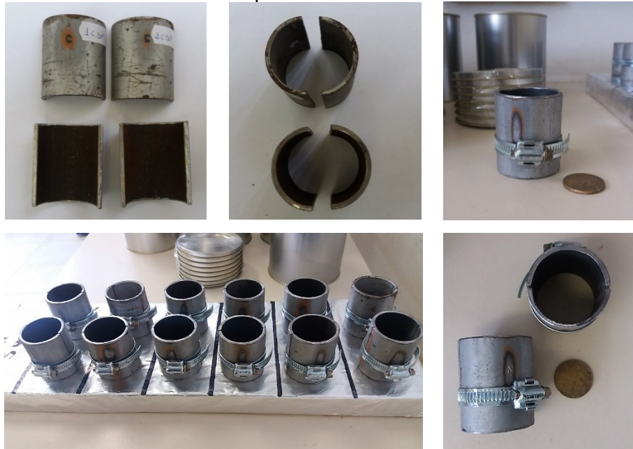
Figura 23 - Características geométricas dos moldes utilizados para confecção dos corpos de prova de MAF.
