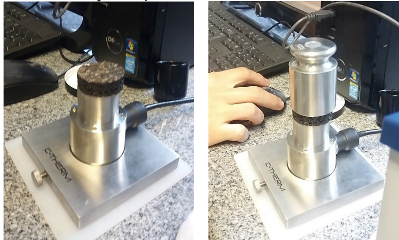
Figura 27 - Equipamento de medição da condutividade térmica das amostras da MAF. A sequência ilustra a disposição da amostra sobre o sensor do equipamento, seguida pela colocação do peso metálico sobre a amostra.
