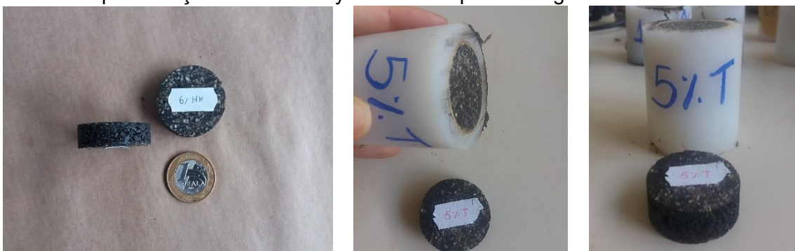
Figura 24 - Amostras extraídas do terço médio dos corpos de prova de MAF e representação do tubo de nylon utilizado para serragem das mesmas.
