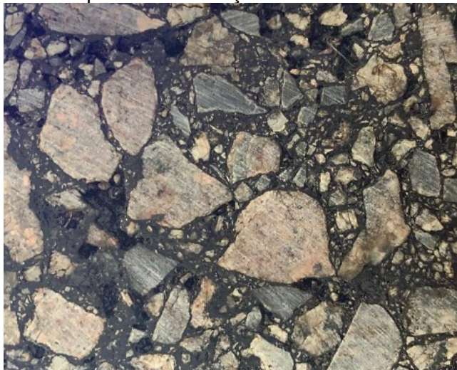
Figura 67 - Superfície do um corpo de prova (5,08 x 6,35 x 38,1 cm) utilizado na análise microscópica da distribuição das fibras metálicas.
