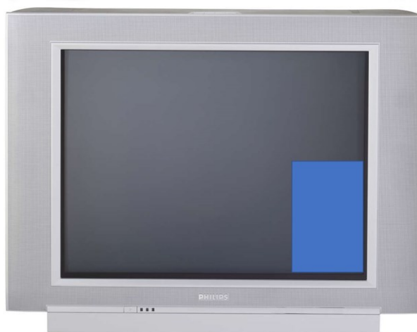
Figura 8 - Tamanho da Janela de Libras proposto pela NBR 15.290/05 para o padrão de transmissão televisivo de 4:3 (quadrado).
